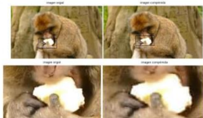
Fig. 5. Comparación entre frame original (izquierda) y comprimido (derecha) al aplicar la DCT al video de muestra
