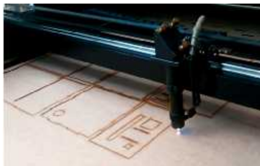
Fig. 4. Corte laser de las piezas del robot
