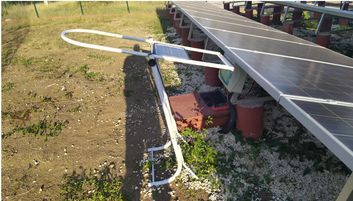
Figura 7: Sistema de medición y registro continuo de la irradiancia solar.
